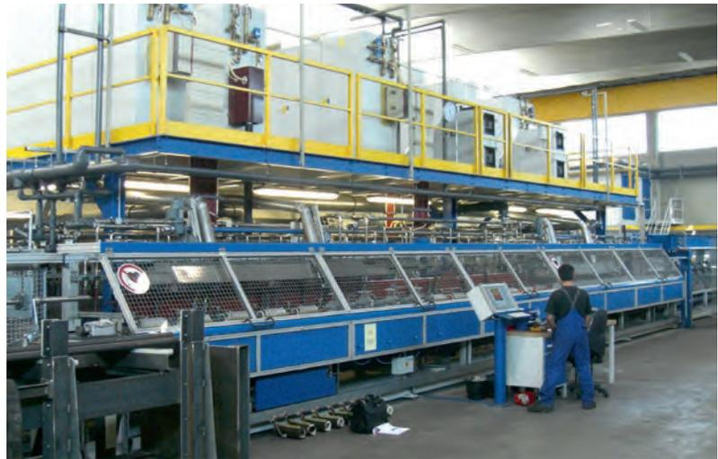
Das komplexe Zusammenspiel zwischen Transporteinheit, induktiver Erwärmung und Abschreckbrause sprechen für diese Lösung aus einer Hand.
