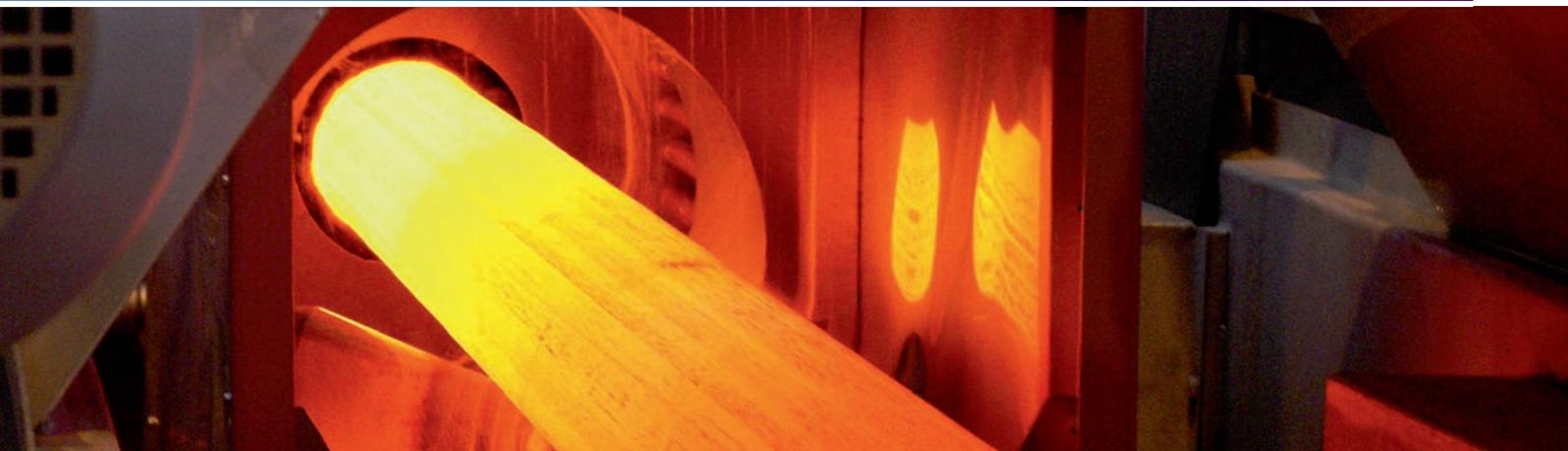
Mit unseren Anlagen werden die Eigenschaften der Werkstoffe verändert. Dabei gibt der Betreiber vor, welche Eigenschaften das Werkstück erreichen soll, die Induktionsanlage wird dementsprechend ausgeführt. Durch eine definierte Leistungsübertragung auf das Bauteil können ganze Chargen von Bauteilen wiederholgenau der Wärmebehandlung unterzogen werden.
