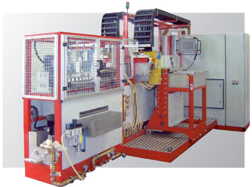
Abhängig von der Teilegeometrie und der Taktzeit ist in einigen Anwendungsfällen ein horizontaler Transport der zu härtenden Bauteile das geeignetere Konzept.
