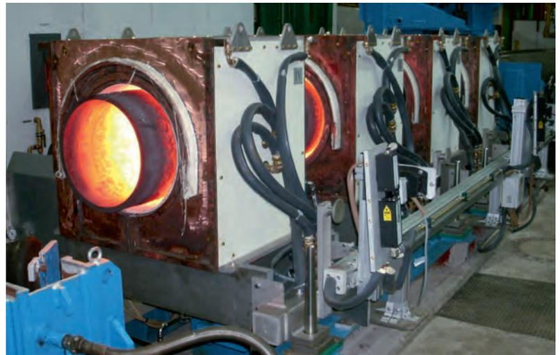
Die kombinierte Härte- und Anlassanlage für Rohre kann je nach den vorhandenen Platzverhältnissen als Inline-Anlage oder in U-Form aufgebaut werden. Verschiedene Spulensätze, die auf den Rohrdurchmesser angepasst sind, erlauben ein breites Spektrum an Rohrdurchmessern.
