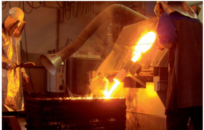
Mittels Induktionsschmelzanlagen werden vorwiegend Metalle verflüssigt. Die Vielfalt an Materialien reicht dabei von Leichtmetallen über Stahl und Schwermetallen bis hin zu Edelmetallen.
