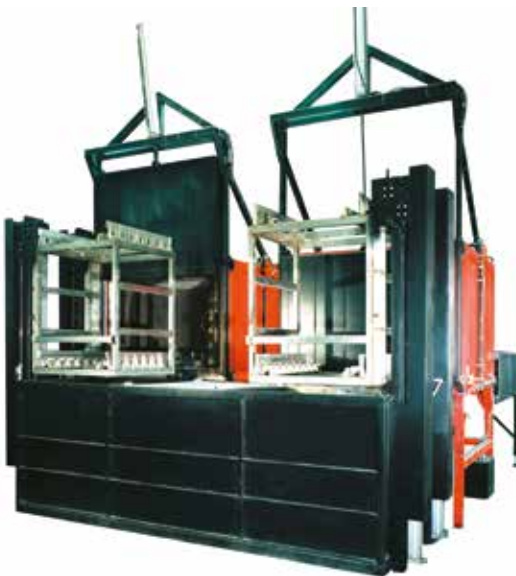
vollautomatische Vergüteanlage zur Wärmebehandlung von Aluminium
