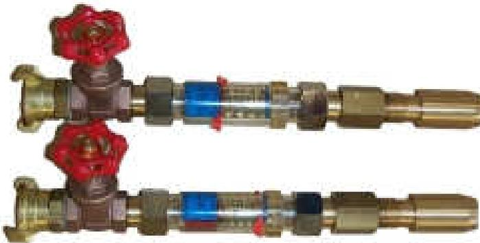
Strahlrohre für IPX5 und IPX6
