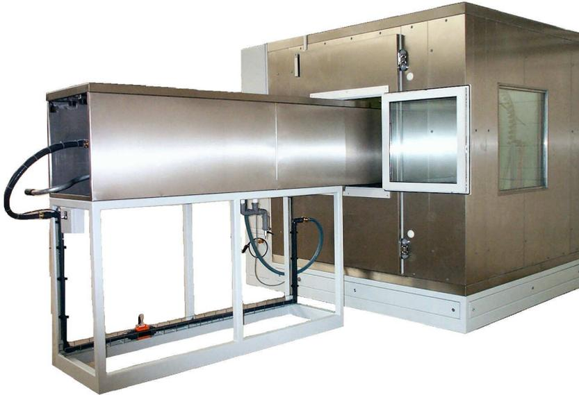
SPK / R800 mit Anbautunnel für die Prüfung nach IPX5 und IPX6
