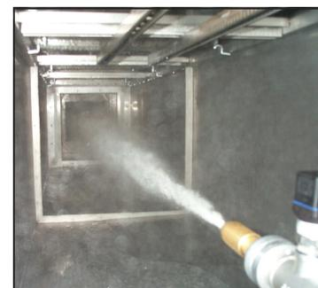
Wasserstrahl im Inneren des Spritzwassertunnels ST 1000
