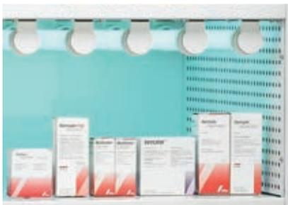
*Photostabilitätstests von Medikamenten gemäß ICH Q1B.*
