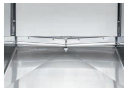
Prüfraumboden mit Gefälle zum Kondensatablauf.
